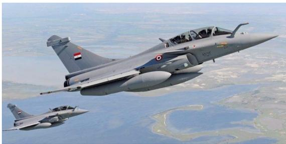
**Il DASSAULT RAFALE** è un aereo da caccia multiruolo francese prodotto dalla Dassault Aviation. È caratterizzato da un'ala a delta e da alette canard, ha una coppia di motori turbofan Snecma M88-2 montati nella sezione di coda e un'unica e ampia deriva. È destinato anche all'esportazione, e molti paesi stranieri hanno dimostrato interesse verso il Rafale, tra cui l'India che nel 2012 è entrata in negoziazione esclusiva con Dassault Aviation per
